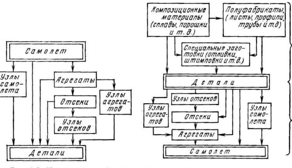
Рис. 1.2. Принципиальная схема деления самолета на составляющие части
