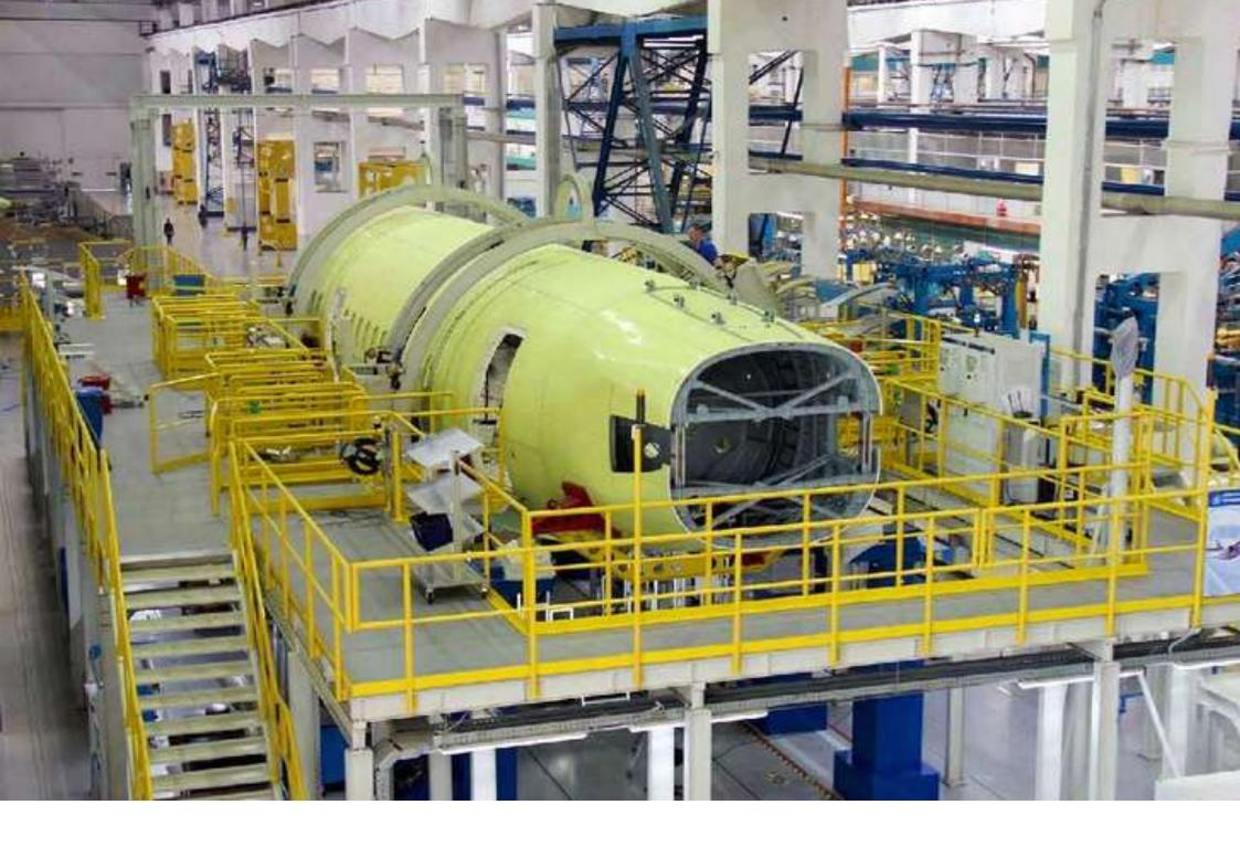
Секция — часть отсека или агрегата, образованная секущими плоскостями, продольными или поперечными по отношению к конструкторским базовым линиям, и не имеющая замкнутого аэродинамического контура. Например, носовая и хвостовая секции крыла, межлонжеронная часть
