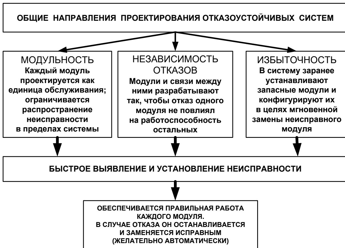
Рис. 1. Направления проектирования отказоустойчивых систем
